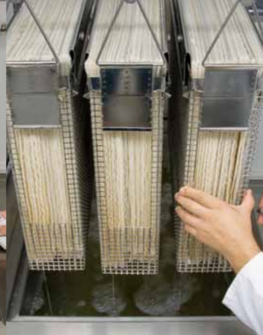
In einem weiteren Becken folgen die Entsäuerung mit angereichertem Wasser (Zusatz von Magnesium- und Calciumsalzen) und die Nachleimung mit Tylose®.
