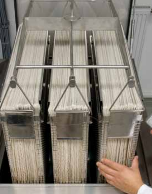
Wegen der dazwischen liegenden Siebschichten kann das Wasser alle Blätter im Korb gut benetzen.
