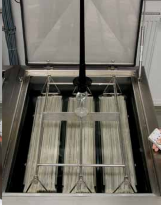
Zunächst kommen die Blätter zur Reinigung in ein Bad mit warmem demineralisiertem Wasser. Anschließend wird mit Leitungswasser gespült.
