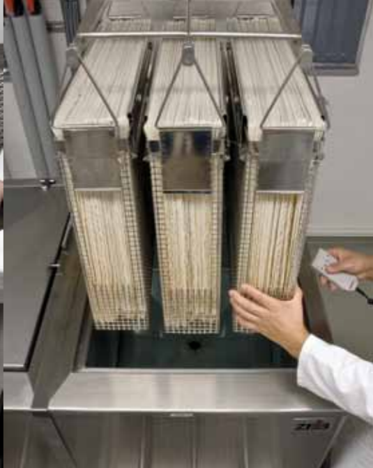
In einem Vertikalwässerungsbecken werden drei Körbe mit insgesamt ca. 150 Blättern gleichzeitig gewässert.
